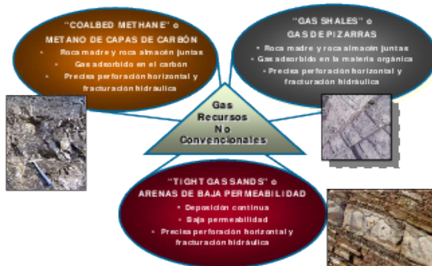
Figura 1. - Tipos de recursos no convencionales de gas: gas de pizarra, gas en capa de carbón y gas de baja permeabilidad
